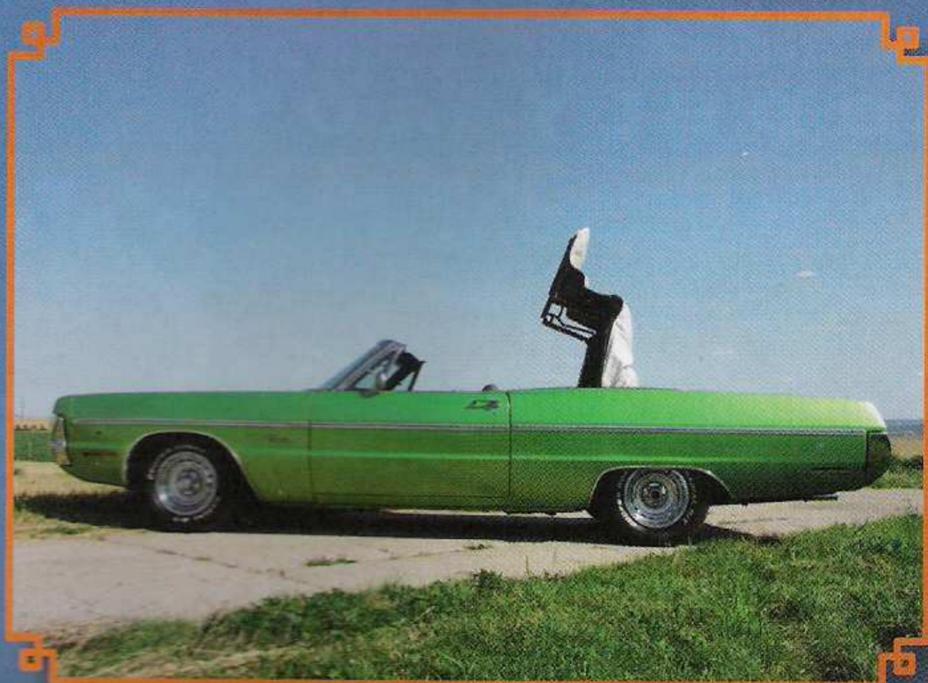
Plátěná střecha je stahována pomocí elektromotorů a poté uložena za zadními sedadly
